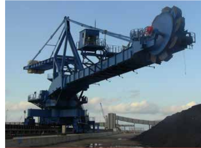
Bom Tip Kovalı İstifleyici Toplayıcı Boom Type Bucket-Wheel Stacker Reclaimer
