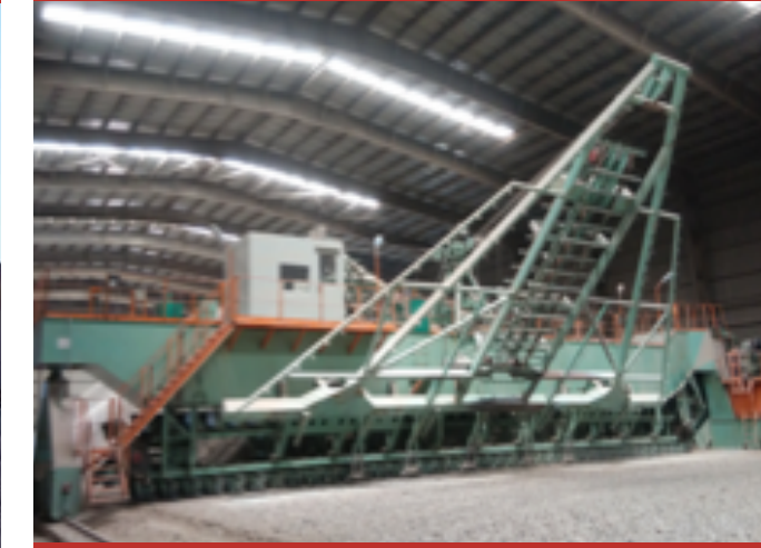
Köprü Tipi Sıyırıcı Toplayıcı Bridge Type Scraper Reclaimer
